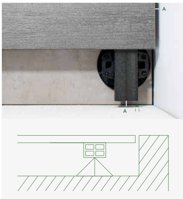
Espace des deux côtés par rapport aux éléments fixes selon la longueur des lames et de la structure porteuse (à une température de pose d'environ 20 °)
